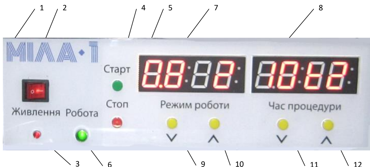
Рисунок 1. Передня панель апарату: 1 – назва апарату; 2 – вимикач живлення; 3 – світлодіодний індикатор включення живлення; 4 – кнопка «Старт»; 5 – кнопка «Стоп»; 6 – індикатор «Робота»; 7 – цифровий індикатор вибраного режиму лікувальної процедури; 8 – цифровий індикатор вибраної тривалості лікувальної процедури; 9 – кнопка встановлення режиму процедури в сторону зменшення; 10 – кнопка встановлення режиму процедури в сторону збільшення; 11 – кнопка встановлення тривалості процедури в сторону зменшення часу; 12 – кнопка встановлення тривалості процедури в сторону збільшення часу
